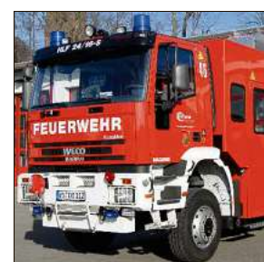
Besonders für Einsätze im Sommerauer Tunnel benötigt die Feuerwehr St. Georgen das Fahrzeug, das auch auf der Schiene fahren kann.
